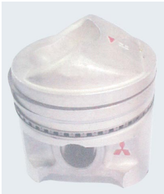
8.16 pav. Tiesioginio benzino įpurškimo variklio stūmoklis
