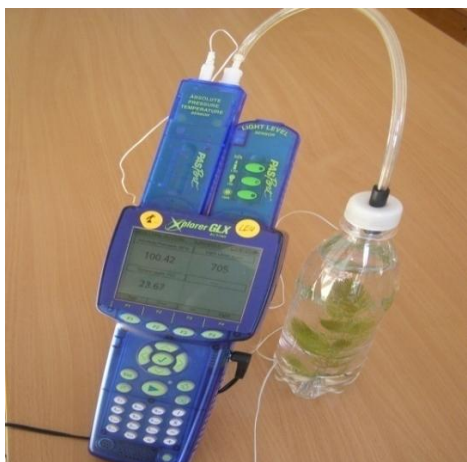
1 pav. GLX'as su apšvietos ir slėgio-temperatūros jutikliu. Į pastarojo temperatūros lizdą įjungtas greito reagavimo temperatūros jutiklis / zondas. Slėgio lizdas vamzdeliu su greito prijungimo-atjungimo gnybtu sujungtas su indu, kuriame vandenyje panardintas augalas. GLX'o skaitmeniniame displėjuje vienu metu matome pradinį slėgį, apšvietimą ir temperatūrą.
