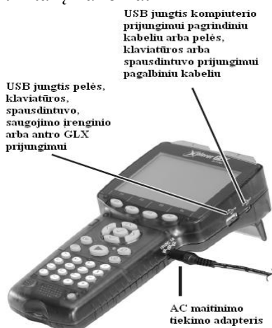
13 pav. Išorinių įrenginių prijungimas prie Xplorer GLX.
