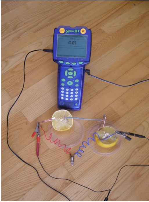
1 c pav. Prijungus 1,5 V; 0,22 A lemputę prie dviejų nuosekliai sujungtų citrinų su vario ir cinko elektrodais lemputė nedega, nors tokio šaltinio E daugiau negu 1,5 V. Voltmetras rodo beveik nulį įtampos krytį ant lemputės. Kaip tai paaiškinti?
