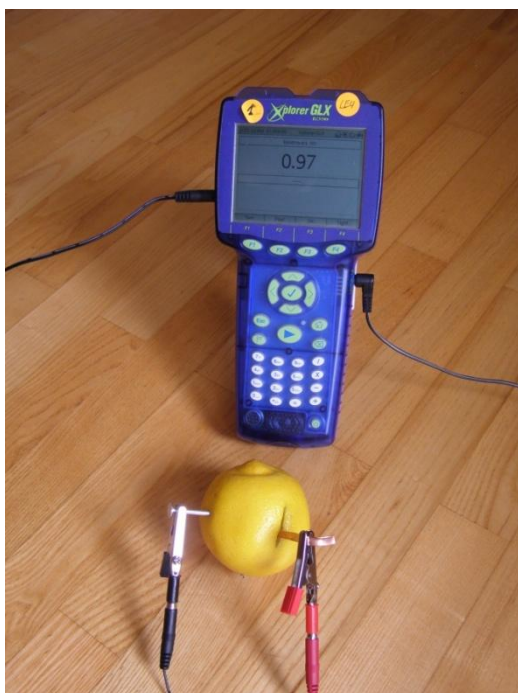
1 a pav. Viena citrina su vario ir cinko elektrodais sukūrė 0,97 V elektrovarą. Kokio tikėtės rezultato, jeigu sujungsite dvi citrinas su vario ir cinko elektrodais nuosekliai?
