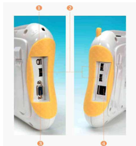
4 pav. Nova 5000 šonuose yra USB jungtis (1,2), CRT jungtis (3) bei interneto jungtis (4).
