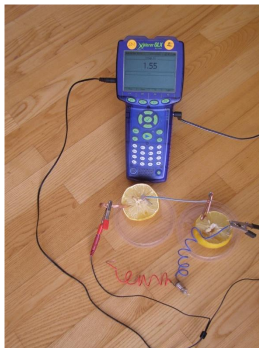
1 b pav. Dvi citrinos su vario ir cinko elektrodais sujungtos nuosekliai sukūrė 1,55 V elektrovarą. (Raudonas laidas prie vario elektrodo neprijungtas.) Kokio tikėtės rezultato, jeigu dabar prie jų prijungsite lemputę?
