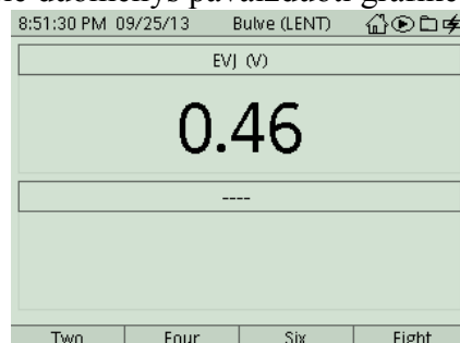
8 b pav. Vario (Cu) ir geležies (Fe) elektrodai bulvėje sukūrė 0,46 V EVJ.
