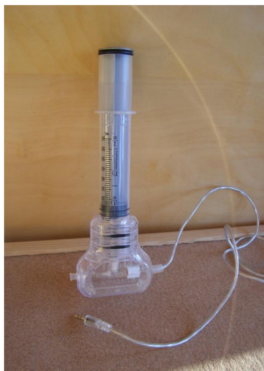
1 pav. Švirkštas, idealiųjų dujų būsenos dėsniui patikrinti. Įrenginys leidžia vienu metu atlikti suspaustų dujų temperatūros ir slėgio matavimus.
