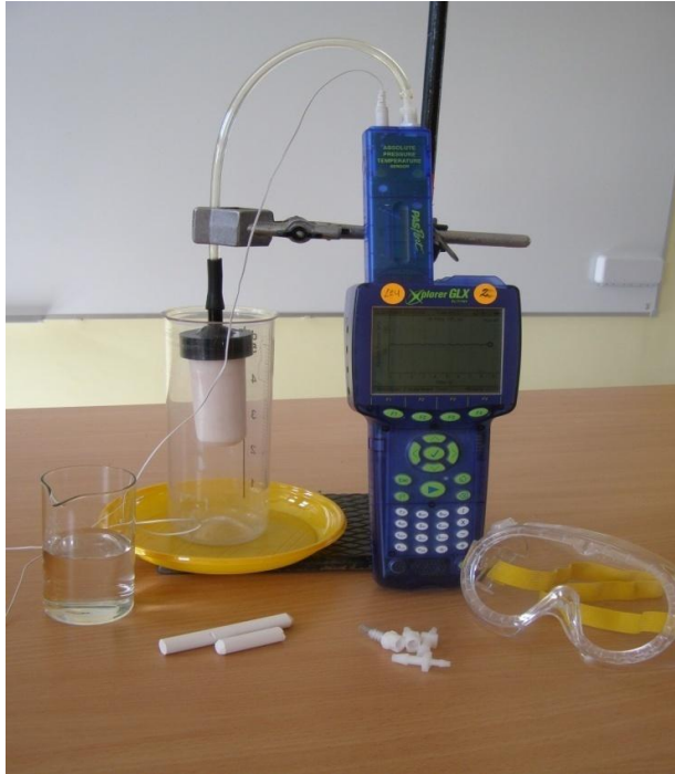
9 pav. Tyrimą atliekant su slėgio-temperatūros jutikliu, vienu metu bus matuojamas slėgio kitimas akytojo indo viduje ir aplinkos temperatūra.
