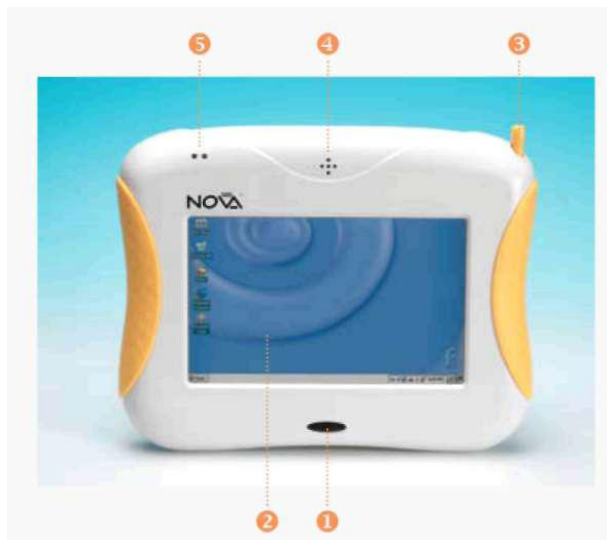
1 pav. Priekinė Nova 5000 pusė: 1 – įjungimo mygtukas, 2 – LCD jutiminis ekranas, 3 – valdymo lazdele, 4 – garsiakalbis, 5 – būsenos lemputės.
