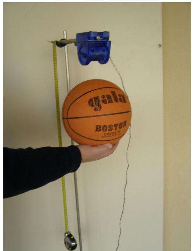
1 a pav. Kamuolys laikomas 15–20 cm atstumu nuo atstumo jutiklio.
