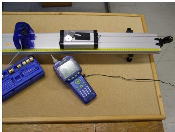
5 a pav. Padėties (atstumo) jutiklis pastatomas ant vieno takelio galo, o vežimėlis su visa numatoma mase, pastatomas 15-20 cm atstumu nuo jo. Prie antrojo takelio galo prisukamas skridinys. Šis takelio galas turi būti prie pat stalo krašto ir išsikišęs virš jo.
