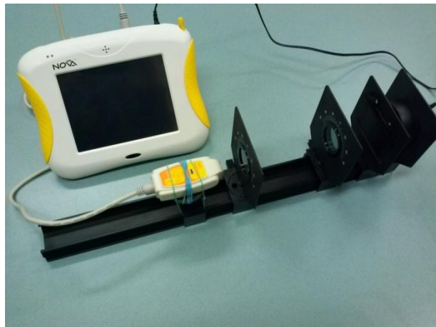
2 pav. Priemonių parengimo darbui schema. Ant optinio suolo (iš kairės į dešinę): apšviestumo jutiklis, analizatorius, poliarizatorius, ekranas su vienu plyšiu, šviesos šaltinis.
