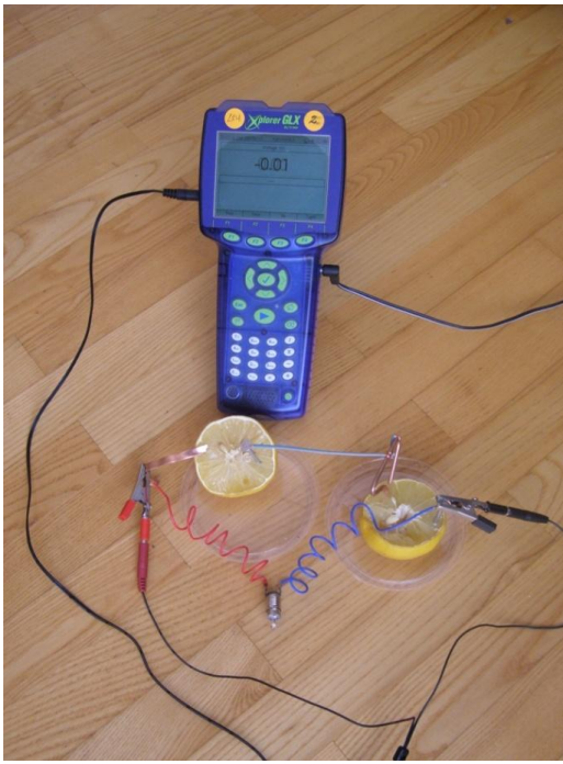
1 c pav. Prijungus 1,5 V; 0,22 A lemputę prie dviejų nuosekliai sujungtų citrinų su vario ir cinko elektrodais lemputė nedega, nors tokio šaltinio E daugiau negu 1,5 V. Voltmetras rodo beveik nulinį įtampos krytį ant lemputės. Kaip tai paaiškinti?
