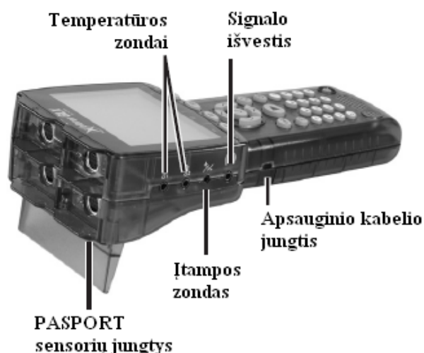
13 pav. Išorinių įrenginių prijungimas prie Xplorer GLX. 14 pav. Xplorer jutiklių ir zondų lizdai
