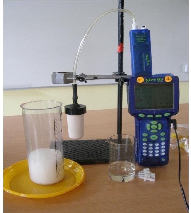
10 pav. Tyrimą atliekant su dvigubo slėgio jutikliu, vienu metu bus matuojamas slėgio kitimas akytojo indo viduje ir aplinkos slėgis. Norint dar matuoti ir aplinkos temperatūrą, į šoninį GLX temperatūros lizdą reikia įjungti greito reagavimo temperatūros jutiklį / zondą.
