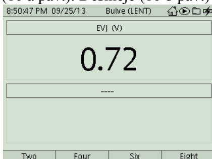
8 a pav. Vario (Cu) ir Cinko (Zn) elektrodai bulvėje sukūrė 0,72 V EVJ.
